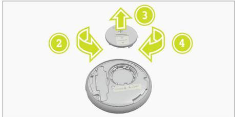
2. Führen Sie ein geeignetes Werkzeug in die Nut des Batteriefachdeckels ein und drehen Sie den Deckel in Pfeilrichtung **2** in die Position Open und nehmen Sie ihn dann ab **3**.
