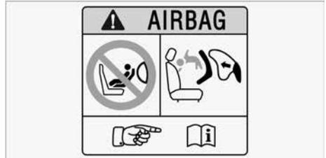
Der Aufkleber für den Beifahrerairbag befindet sich an der Sonnenblende des Beifahrers.
