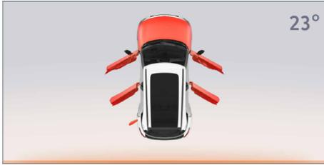
Wenn sich das Fahrzeug im Parkmodus **P** /Drive **D** /reverse **R** befindet und eine der Türen, die Motorhaube, die Heckklappe oder die Abdeckung des Ladeanschlusses geöffnet wird, leuchtet die Türstatusanzeige rot und ein Alarm ertönt, um den Fahrer auf den Status der entsprechenden Tür hinzuweisen.
