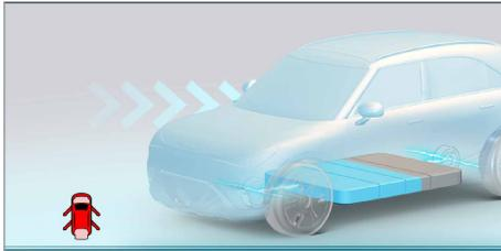
Wenn beim Laden/Entladen des Fahrzeugs eine der Türen, die Fronthaube, die Heckklappe oder die Abdeckung des Ladeanschlusses geöffnet wird, leuchtet die Anzeige auf dem Fahrerinformationsbildschirm auf, um den Fahrer auf den Status der entsprechenden Tür hinzuweisen.
