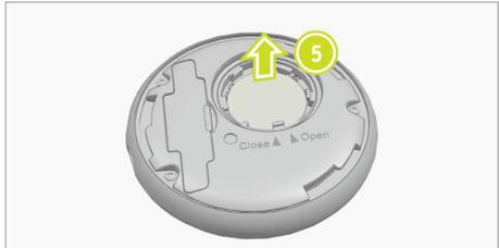
3. Entfernen Sie die Batterie des Funkschlüssels **5**.
