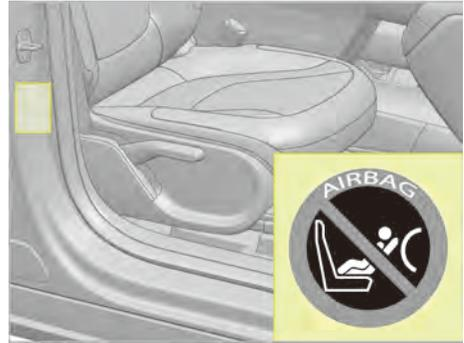
Der Aufkleber ist an der B-Säule auf der Beifahrerseite sichtbar, wenn die Beifahrertür geöffnet wird.
