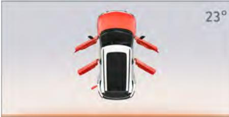
Wenn sich das Fahrzeug im Parkmodus **P** /Drive **D** /reverse **R** befindet und eine der Türen, die Motorhaube, die Heckklappe oder die Abdeckung des Ladeanschlusses geöffnet wird, leuchtet die Türstatusanzeige rot und ein Alarm ertönt, um den Fahrer auf den Status der entsprechenden Tür hinzuweisen.
