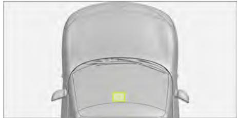
Der Regen-Licht-Sensor befindet sich im oberen Teil der Windschutzscheibe und die Funktionen der automatischen Scheibenwischer / des automatischen Fahrlichts / der automatischen Klimaanlage werden über diesen Sensor gesteuert.
