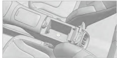
2. Legen Sie den Funkschlüssel wie in der Abbildung gezeigt in das Armlehnenfach.
