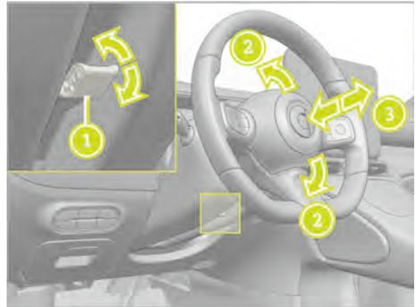
1. Klappen Sie den Hebel ① nach unten, um die Lenksäule zu entriegeln.
