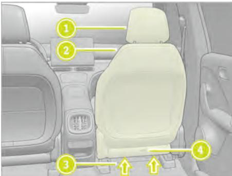
1. Entfernen Sie gegebenenfalls die Kopfstütze ① oder schieben Sie sie nach oben.
