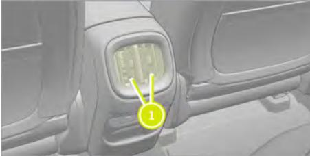
1. **Einstellen des hinteren Luftauslasses:** Bewegen Sie die Schieber ① nach oben, unten, links und rechts, um die Richtung des Luftauslasses einzustellen. Drehen Sie die Schieber ① nach unten in die maximale Position, um die Luftauslässe zu schließen.
