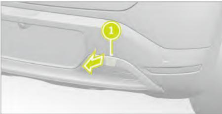
4. Verwenden Sie ein geeignetes Werkzeug, um die Abdeckung der hinteren Abschleppstange <sup>①</sup> zu entfernen.
