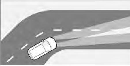
Die Kurvenbeleuchtung kann eine breite Palette von Fahrbahnbeleuchtungseffekten in der Abbiegerichtung des Fahrzeugs bieten, wodurch die Straßenverhältnisse innerhalb des Abbiegebereichs leichter zu erkennen sind.
