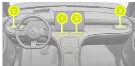
1. **Einstellen der Luftauslässe auf der Fahrerseite:** Bewegen Sie die Schieber ① nach oben, unten, links und rechts, um die Richtung der Luftauslässe einzustellen. Drehen Sie die Schieber ① zu den Seiten des Fahrersitzes in die maximale Position, um die Luftauslässe zu schließen.
