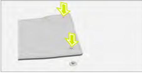
Legen Sie die Fußmatten in die richtige Position, richten Sie die Ösen der Fußmatten an den Halteklammern der Fußmatten aus und drücken Sie sie an, bis sie einrasten.
