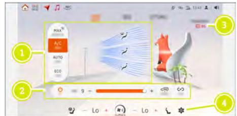
**MAX** Aktivieren/Deaktivieren der maximalen Klimasteuerung
