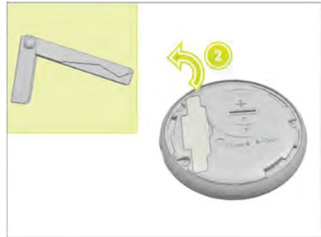
2. Öffnen Sie die Abdeckung der mechanischen Taste in Pfeilrichtung ② und nehmen Sie den mechanischen Schlüssel heraus.
