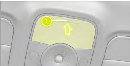
Drücken Sie auf ① in Pfeilrichtung, um das Brillenfach in der Mitte des Dachhimmels zu öffnen.
